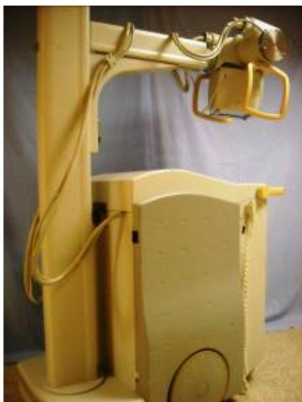
Máquina utilizada para la realización de radiografías que por su movilidad permite su utilización a pie de cama y en salas no específicamente ubicadas en el servicio de radiología.
