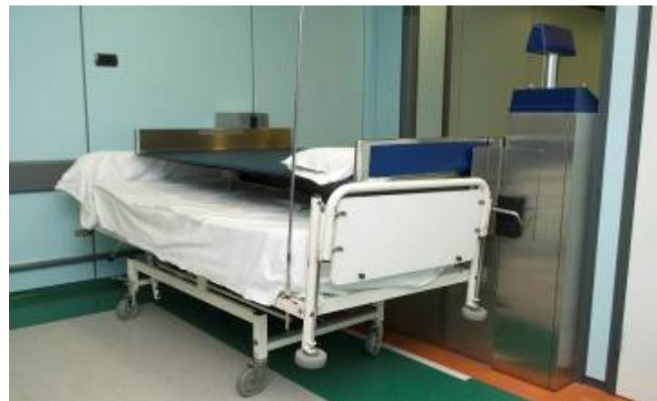
Una vez realizada esta operación, comenzamos los movimientos indicados en los mandos, tienen señaladas todas las posiciones para su manejo, una pequeña pantalla nos indica los movimientos que se están realizando y con el mínimo esfuerzo (levantar al enfermo un poco lateralmente para introducir la plancha) trasportamos al paciente. No permitiéndonos ningún movimiento, si detecta fallos en el posicionamiento de la cama o mesa de operaciones, evitando así errores en el traslado.
