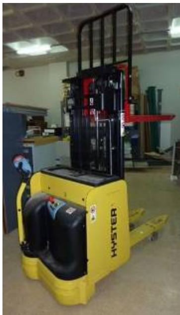
Equipo autopropulsado de tracción eléctrica, utilizado para la elevación y transporte del material.
