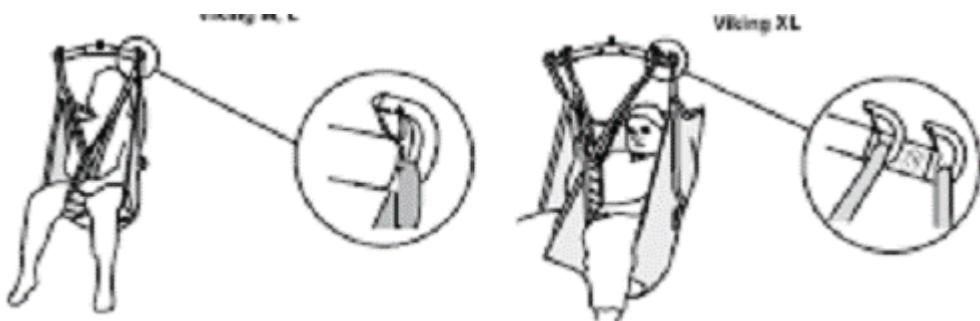
**Desde la posición Semi-incorporado en la cama o sentado en una silla:** colocar el arnés de arriba-abajo, por detrás y por debajo de una sábana entremetida, hasta la altura de la cintura. Pasar las bandas de las piernas, justo por debajo de cada muslo y a continuación asegurarlas a las grúas según las indicaciones del fabricante.
